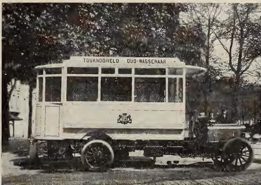
Fig. 55. — Omnibus pétroléo-électrique, système Tilling-Stevens, en service à Londres.
