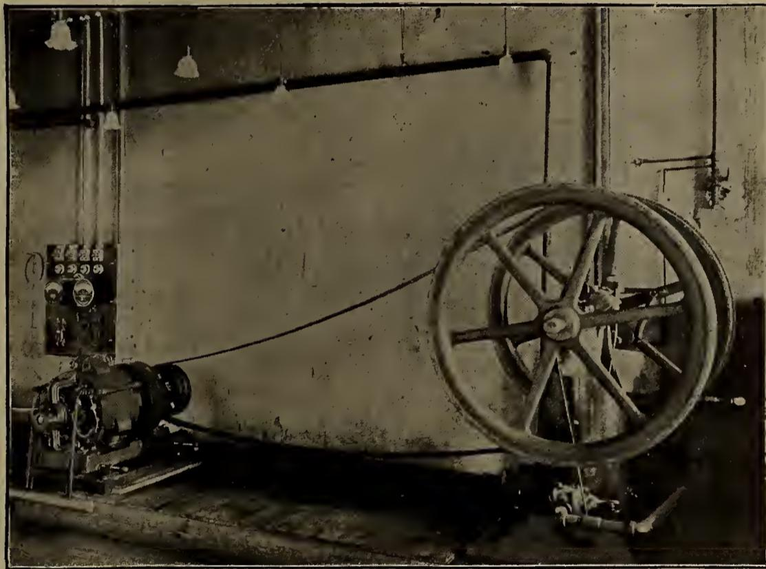
NEW GAS ENGINE FOR ELECTRIC LIGHTING.
